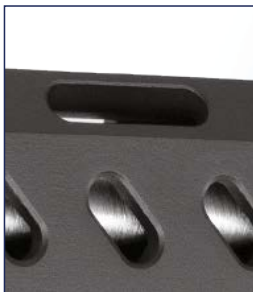
Los compensadores reducen el retroceso
